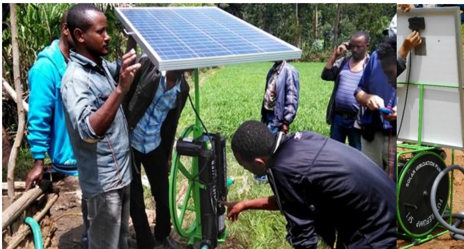
ምስል 4: በፀሐይ ኃይል የሚንቀሳቀስ የውኃ ፓምፖች ዓይነቶች የመስክ አጠቃቀም
